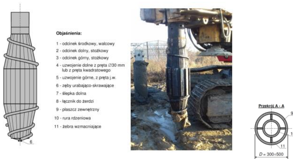
Rys. 2 Schemat świdra DPDT
